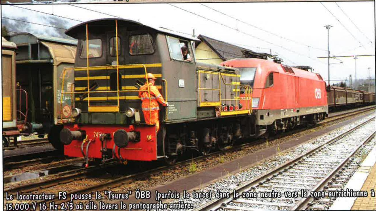
Le locotracteur FS pousse la "Taurus" ÖBB (parfois la lance) dans la zone neutre vers la zone autrichienne à 15.000 V 16 Hz 2/3 où elle lèvera le pantographe arrière.
