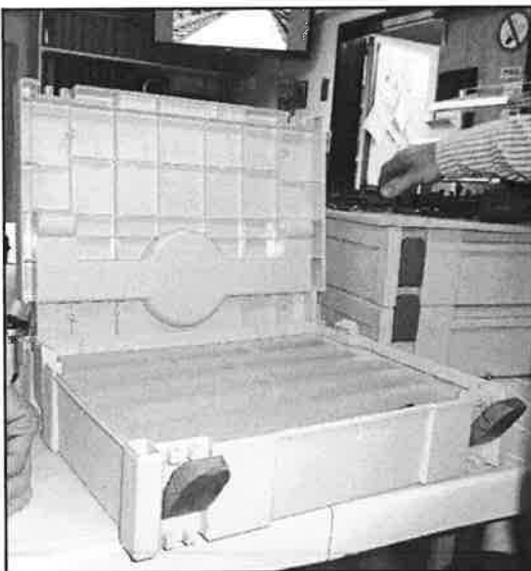
L'intérieur est garni d'un bloc de mousse compacte. Celle-ci a été découpée au fil chauffant. Les découpes sont plus propres qu'exécutées à la scie ou au cutter.
