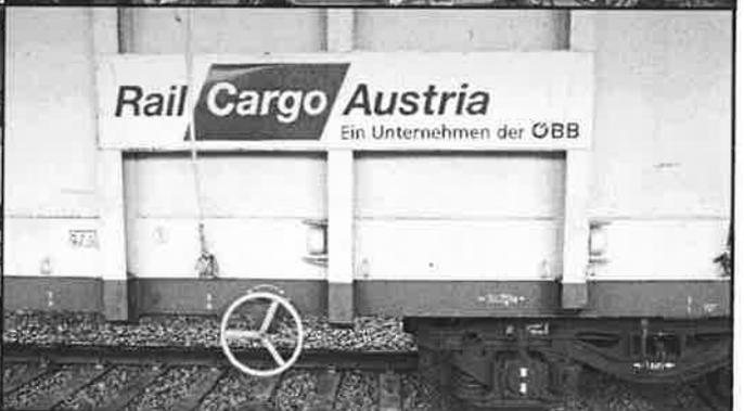
A gauche, en haut : détecteur d'information des balises; en bas : les pièces magnétiques sur la roue pour la détection du patinage.
